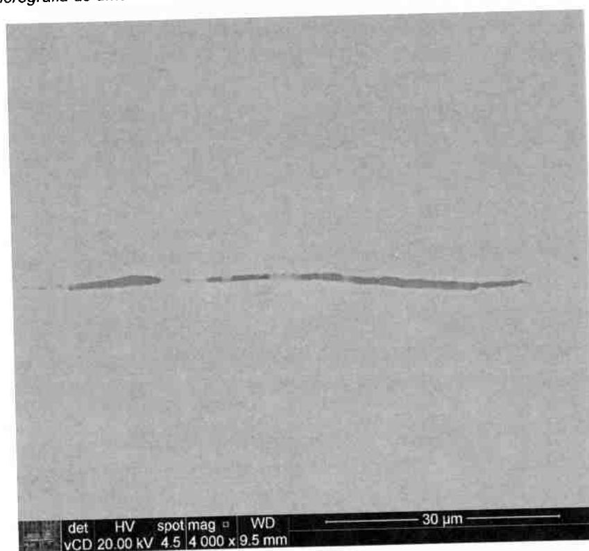
Figura 50: Micrografia de uma inclusão da amostra SAE5160 com tratamento térmico à 10000°C e 4 horas
