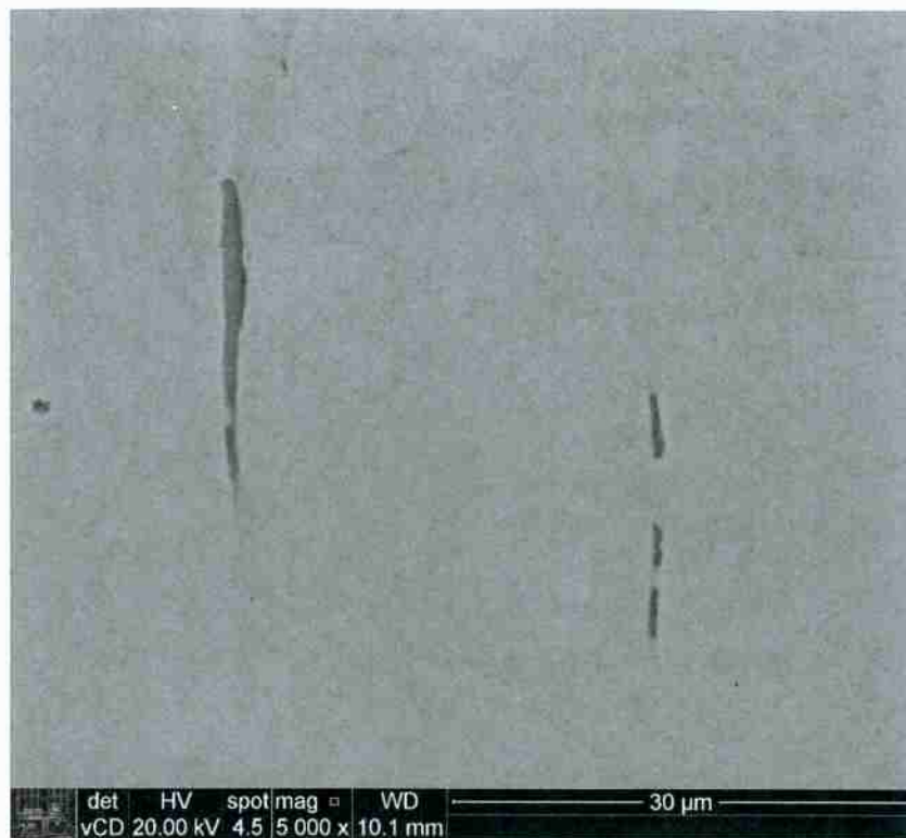
Figura 47: Micrografia de uma inclusão da amostra SAE5160 com tratamento térmico à 1000°C e 2 horas
