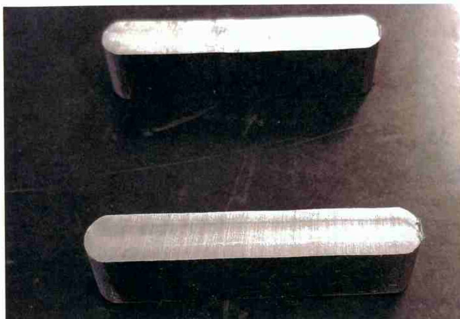
Figura 5: Amostras de aço SAE 5160 após corte na serra fita
