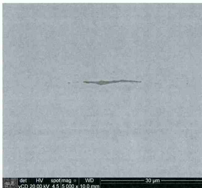
Figura 44: Micrografia de uma inclusão da amostra SAE5160 com tratamento térmico à 800°C e 6 horas
