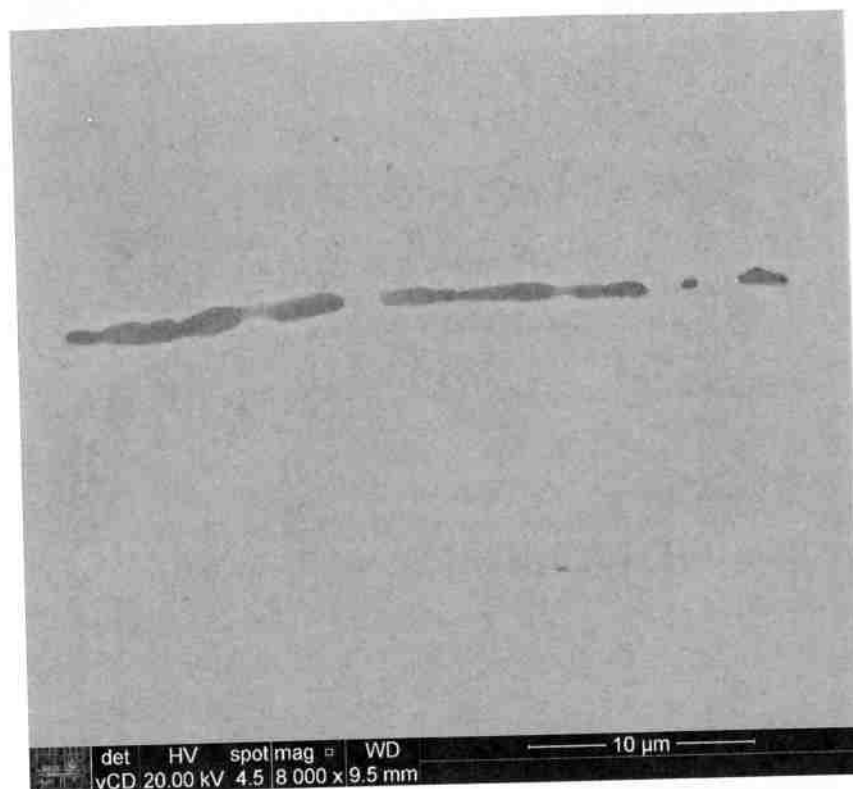
Figura 49: Micrografia de uma inclusão da amostra SAE5160 com tratamento térmico à 1000°C e 4 horas
