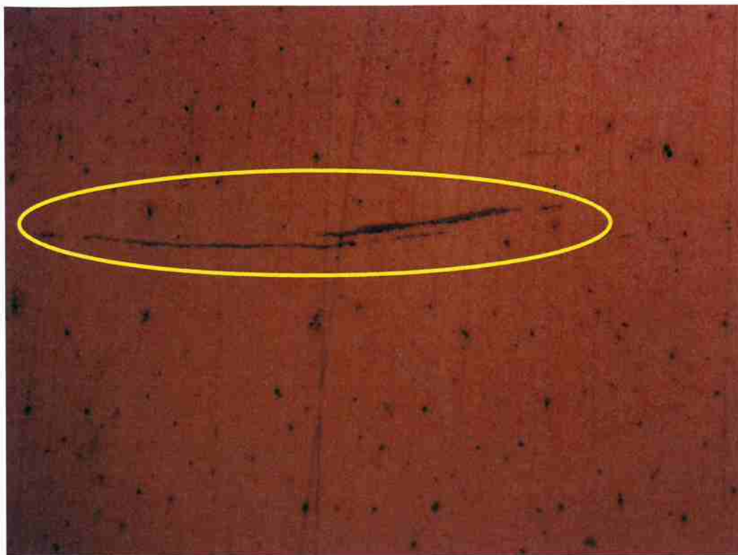
Figura 28: Micrografia no microscópio óptico da amostra SAE5160 sem tratamento térmico
