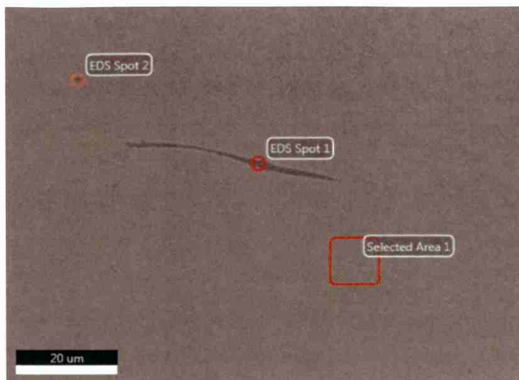
Figura 18: Pontos e áreas selecionadas para a realização do EDS no aço SAE5160
