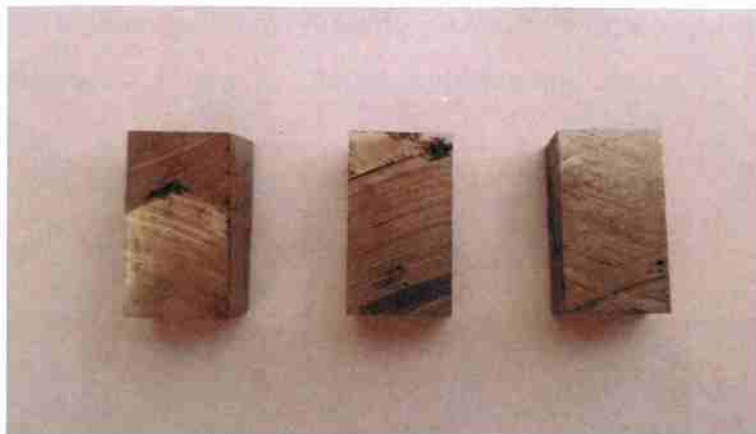
Figura 9: Corpos de provas do SAE6150 cortadas na serra cutoff
