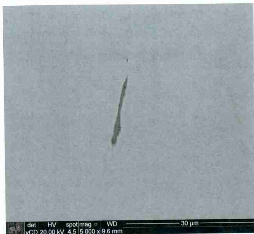
Figura 40: Micrografia de uma inclusão da amostra SAE5160 com tratamento térmico à 800°C e 2 horas
