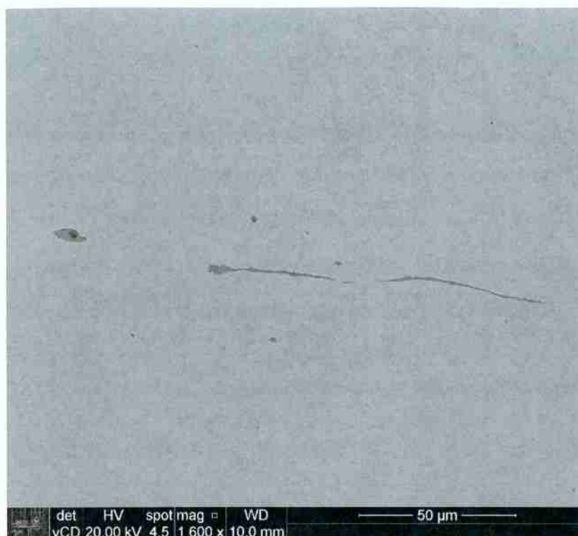
Figura 44: Micrografia de uma inclusão da amostra SAE5160 com tratamento térmico à 800°C e 6 horas
