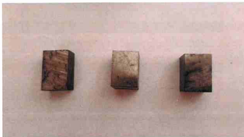
Figura 8: Corpos de prova do aço SAE5160 cortadas na serra cutoff
