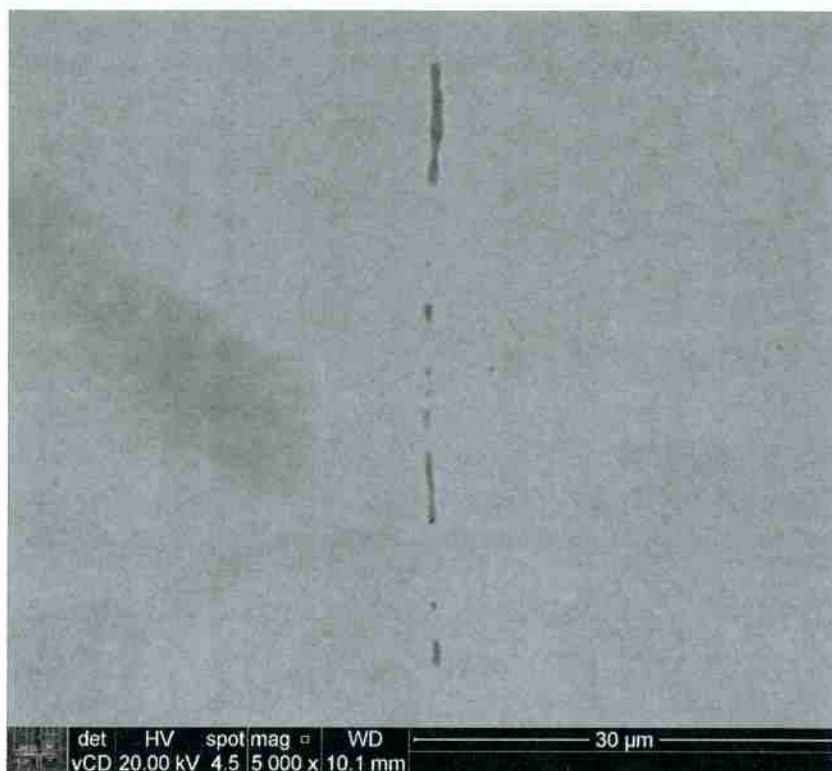
Figura 48: Micrografia de uma inclusão da amostra SAE5160 com tratamento térmico à 1000°C e 2 horas
