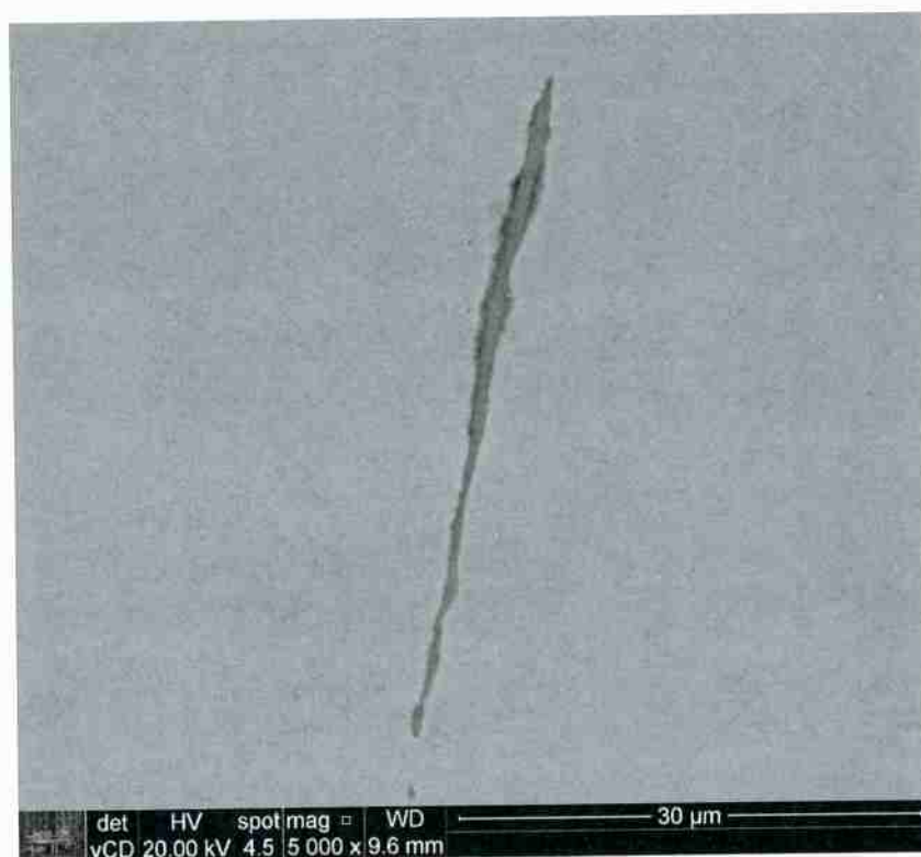
Figura 40: Micrografia de uma inclusão da amostra SAE5160 com tratamento térmico à 800°C e 2 horas
