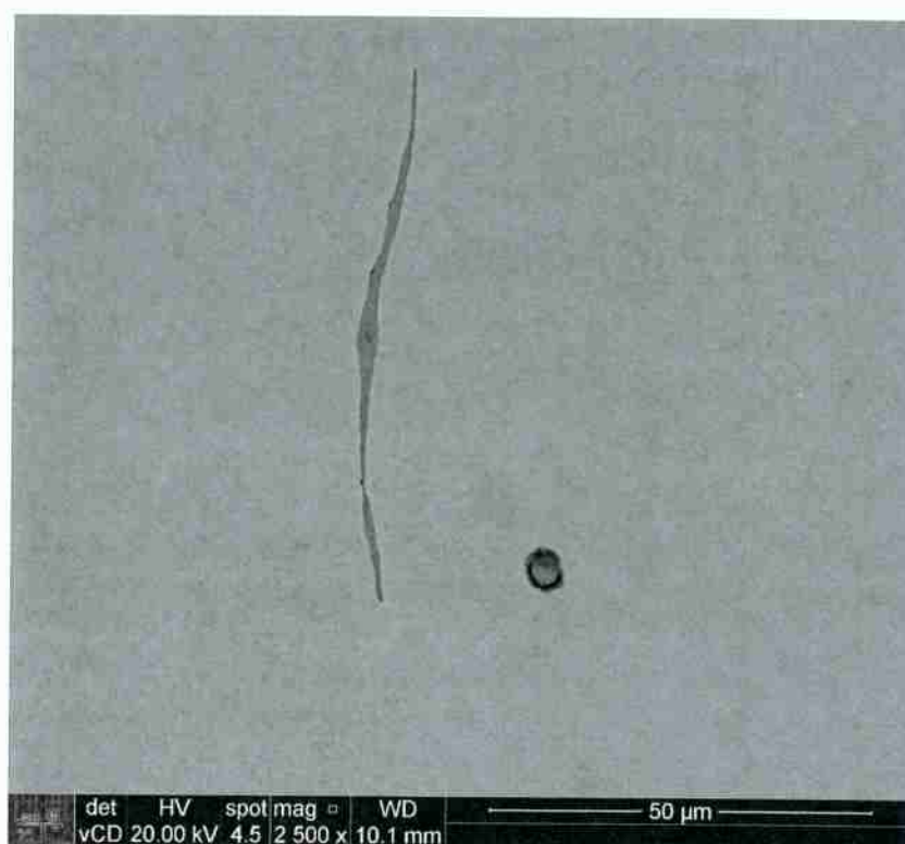
Figura 42: Micrografia de uma inclusão da amostra SAE5160 com tratamento térmico à 800°C e 4 horas
