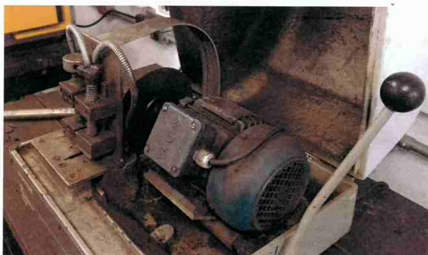
Figura 11: Detalhamento interno da serra cutoff
