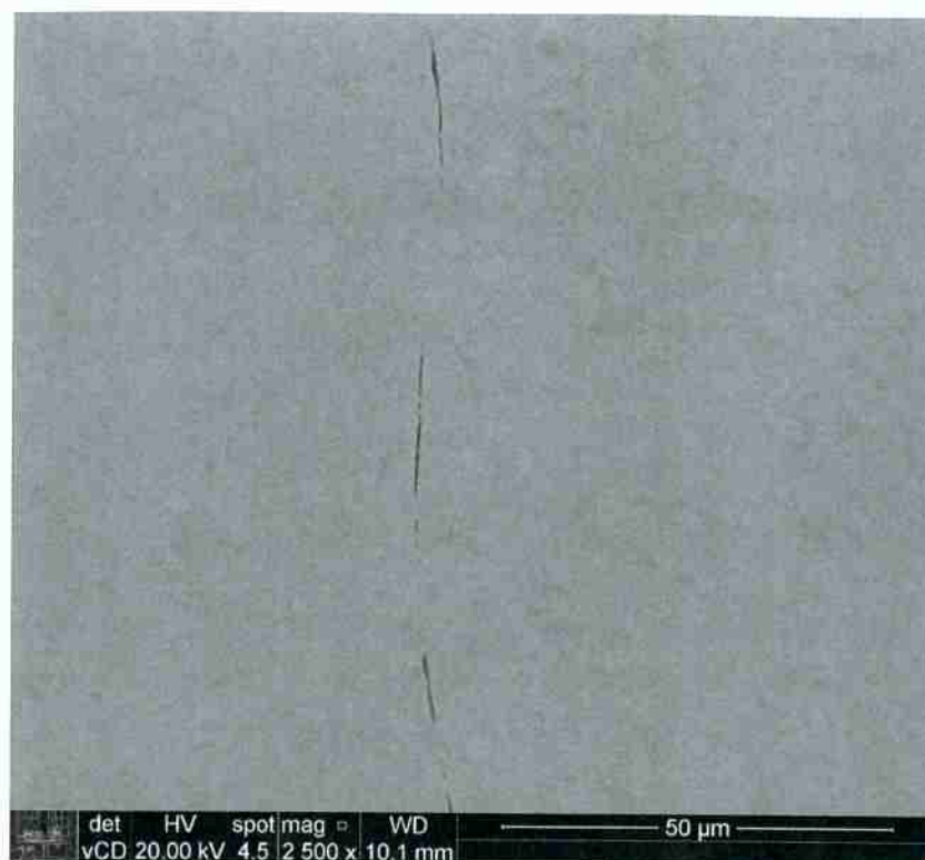
Figura 42: Micrografia de uma inclusão da amostra SAE5160 com tratamento térmico à 800°C e 4 horas
